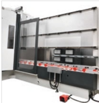
Equipado con rodillos locos a la entrada de la máquina, con la posibilidad de motorizarlos.
