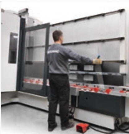
Equipado con rodillos locos a la entrada de la máquina, con la posibilidad de motorizarlos.
